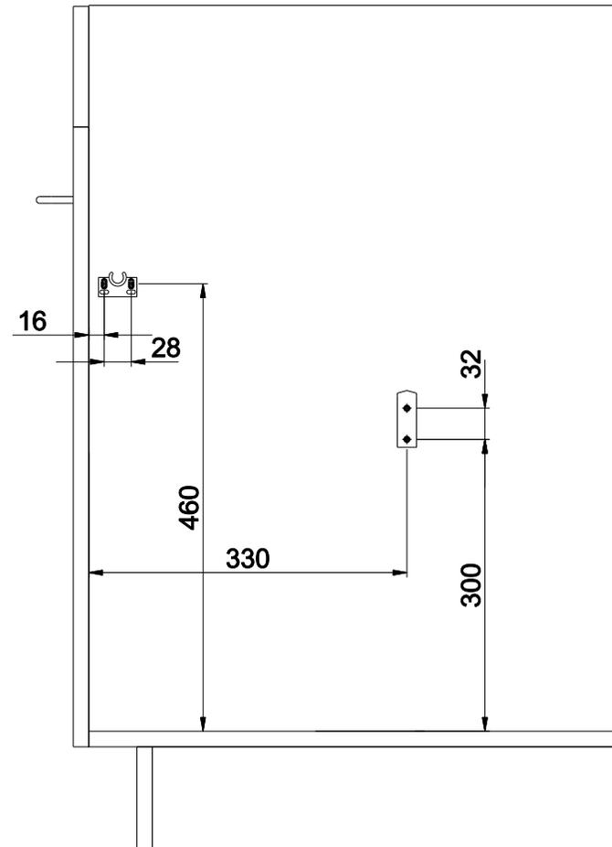
Bohrbilder: Front / Kastenboden / Seitenwand L+R
